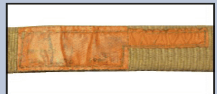
ETIQUETA FALTANTE O ILEGIBLE
